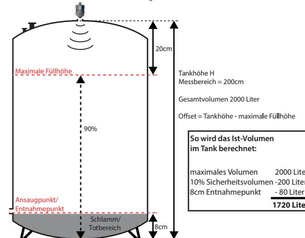
Abb. 9 - Beispiel für Tanks mit Offset
